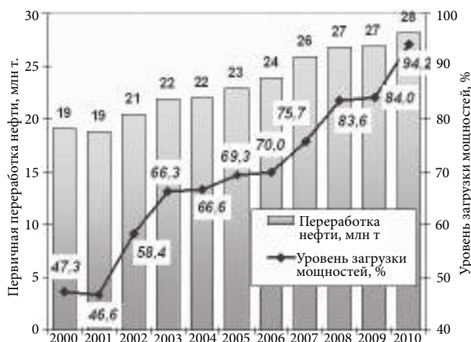
Рис. 2. Первичная переработка нефти и уровень загрузки мощностей НПЗ в Восточной Сибири и на Дальнем Востоке в 2000–2010 гг.
